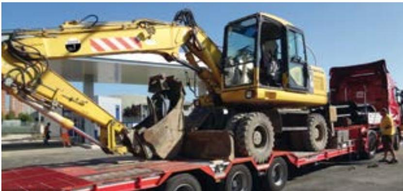
Figura F.11 - Vista del mezzo d'opera utilizzato per l'infissione di palotiranti Geopal® in un cantiere a Livorno.
