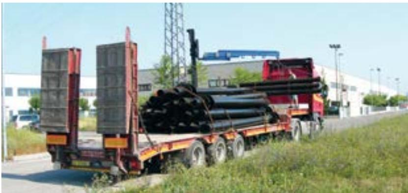
Figura F.12 - Inquadramento di un autotreno durante la fase di scaricamento di pali Geopal® modello P2G ad alto tonnellaggio.
