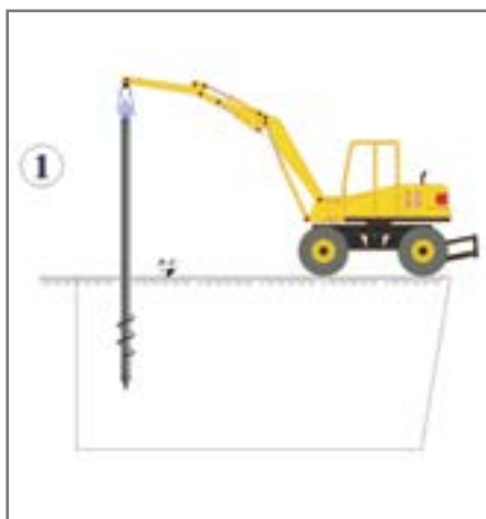
1 Infissione pali a quota di progetto
