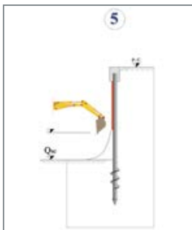
5 Ultimazione dello sbancamento
