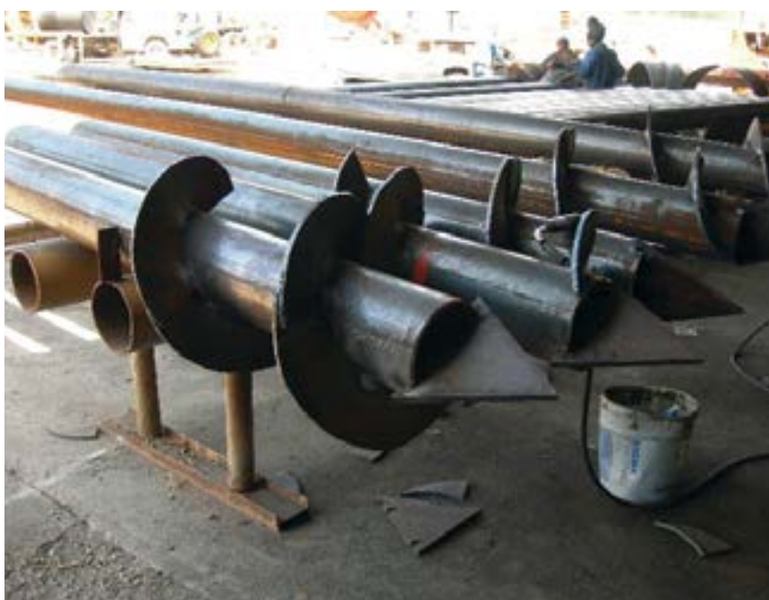
Pali Geopal® utilizzati dalle NASE C.A. per il sostegno di una condotta idraulica a sud di Caracas in Venezuela.
