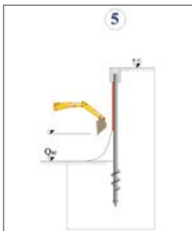
Ultimazione dello sbancamento
