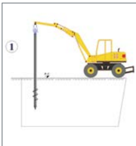
Infissione pali a quota di progetto
