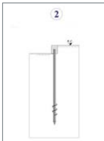
Cordolatura delle teste dei pali
