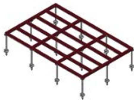
Particolare del solaio portante in HEA poggiante sulla testa di un palo Geopal®.
