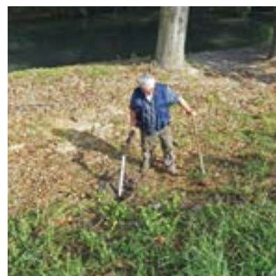
Figura E.14 - Rilevazioni del sottosuolo con magnetometro digitale
