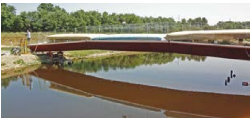
Figura E.31 - Prova di carico strutturale eseguita sul ponte ciclopedonale del sito archeologico Ravenna Antica (Giugno 2015). Il test è stato eseguito con l'ausilio di materassi d'acqua stesi sopra l'impalcato del ponte e riempiti fino al raggiungimento di 5 kN/mq.
