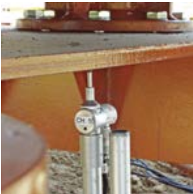
Figura E.30 - Particolari delle strumentazioni utilizzate per misurare i cedimenti strutturali prodotti sotto l'azione dei carichi agenti.
