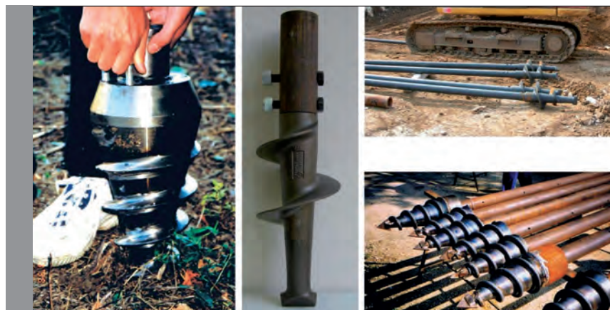
Figura 64. Particolare di una punta a vite conica dei pali Pressopal ideati dal geologo Gian Pietro Frare.
