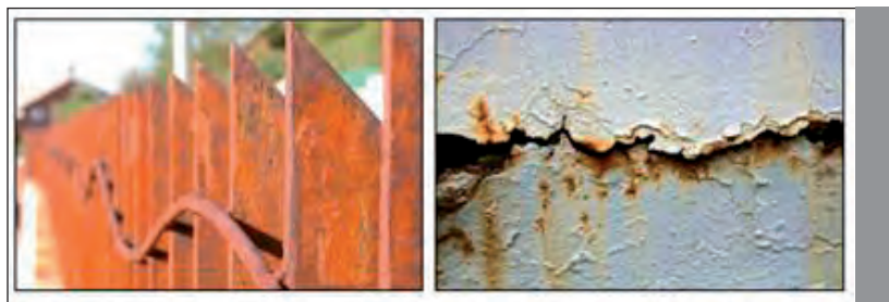
Figura 97. Ossidazione del metallo per azione dell'ossigeno e dell'umidità atmosferica.
