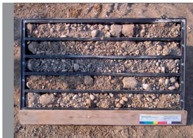
Sondaggio S1-SAN GIUSEPPE – Cassetta N. 3 : da 10.0 m a 15.0 m
