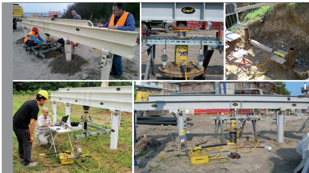
Figura 71. Prove di carico su pali da portata.
