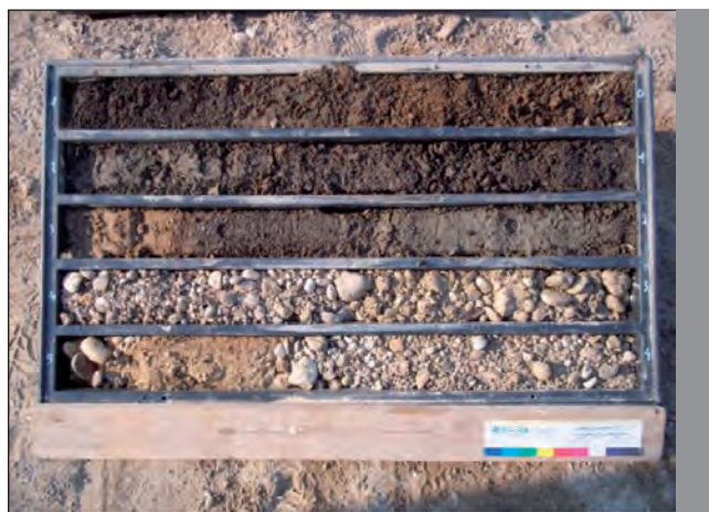
Sondaggio S2-SAN GIUSEPPE – Cassetta N. 1 : da 0.0 m a 5.0 m
