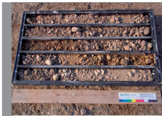
Sondaggio S1-SAN GIUSEPPE – Cassetta N. 2 : da 5.0 m a 10.0 m
