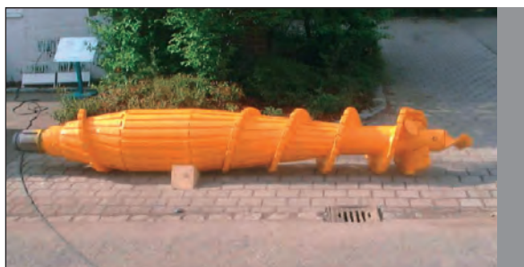
Figura 60. Utensile a forma ad ogiva utilizzato per realizzare i pali CFA.
