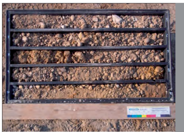
Sondaggio S2-SAN GIUSEPPE – Cassetta N. 2 : da 5.0 m a 10.0 m
