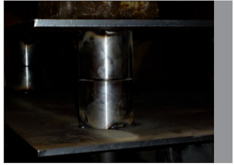
Figura 95. Isolatori sismici a scorrimento utilizzati su pali a vite prodotti da GeopallItalia S.r.l.
