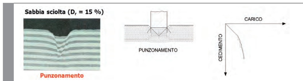
Figura 7. Rottura per punzonamento.
